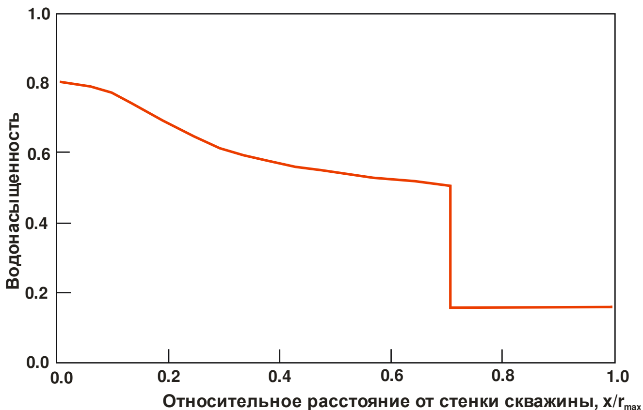
Рисунок 1.9 – Классическое распределение водонасыщенности по модели Баклея – Леверетта [Aziz et. al., 1979]
