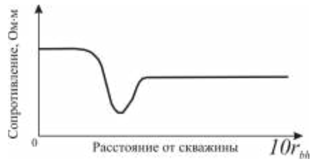
Рисунок 1.4 – Радиальное распределение УЭС при наличии окаймляющей зоны. [Технология исследования нефтегазовых скважин на основе ВИКИЗ, 2000]
