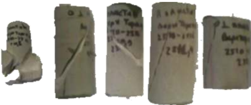
Рисунок 2.8 – Образцы керна, прошедшие испытания на трехосное сжатие
