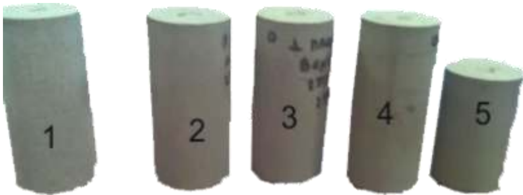
Рисунок 2.7. Образцы керна, отобранные для геомеханических испытаний
