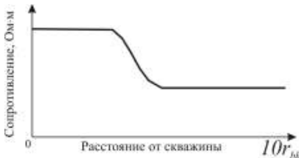
Рисунок 1.3 – Радиальное распределение УЭС в модели «зона» повышенного проникновения – пласт. [Технология исследования нефтегазовых скважин на основе ВИКИЗ, 2000]
